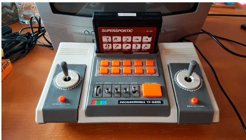
Soundic SD-050: vaihdettavia AY-sarjan piirejä moduuleilla käyttävä konsoli.
